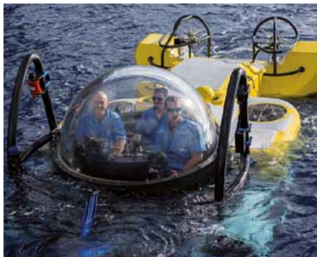
Fig. 37 El submarino DeepSee, propiedad de la empresa Undersea Hunter, utilizado en la expedición a las Islas Desventuradas en febrero de 2013. El submarino está tripulado por un piloto y dos pasajeros, y puede descender hasta una profundidad de 450 m.
